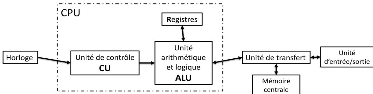
CPU (Unité Centrale de Traitement), microprocesseur ou processeur se compose de :
